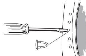
6. Insérer une vis dans la deuxième ouverture à partir du haut de l'ouverture de la charnière et la serrer partiellement. Suspendre la porte en plaçant le trou de serrure supérieur de la charnière par-dessus la tête de la deuxième vis et serrer la vis. En plaçant cette vis en premier, la porte sera suspendue en place pendant que vous insérez et serrez les 4 autres vis.
