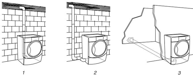
1. Acheminement standard du conduit d'évacuation par l'arrière
